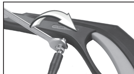
Montáž tlak. hadice k pištoľi u modelu 8895200, Obr.8
