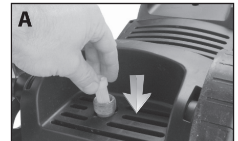
Montage des Druckschlauchs zur Pistole beim Modell 8895200, Abb. 8
