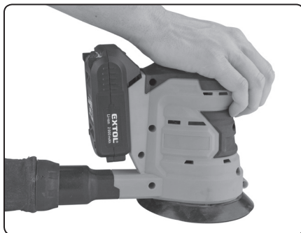
Obr. 5, vedenie brúsky po brúsenom povrchu rukou
